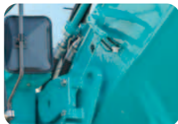
ブーム角度センサ(転倒防止警報装置)
